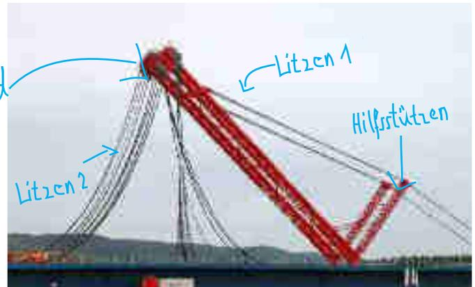
Verwendung der „Litzen 2“. Immer wieder müssen die schweren Stahlseile neu sortiert und geordnet werden.
