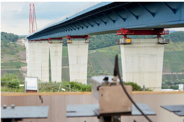
↑ Der Long-Distance-Sensor visiert während des Messvorgangs die Reflektoren an den jeweiligen Pfeilern an.
